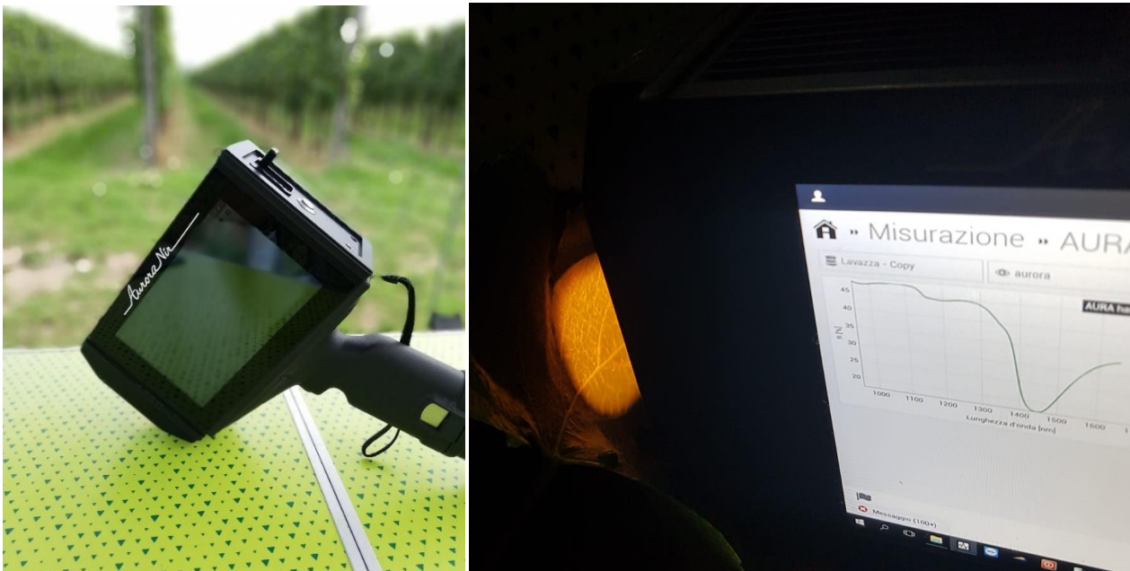
Figura 2. Sistema AuroraNIR di GrainIT e particolare di una misura notturna su foglia di vite.
